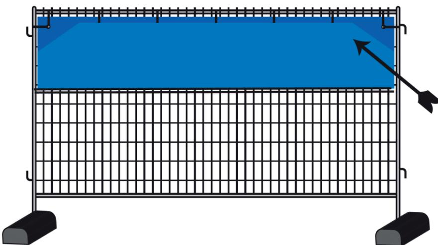
► Fixez les attaches de câble sur le côté supérieur de la clôture tous les 50 cm, en poussant l'attache de câble à travers le filet juste en dessous du renforcement et resserrez les.
