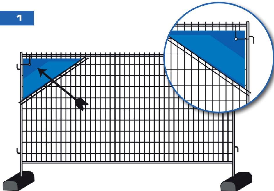
► Commencez par fixer les deux coins supérieurs, en utilisant 2 serre-câbles; 1 horizontal, 1 vertical
