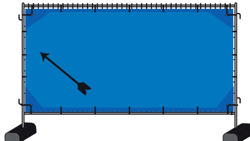
► Fixer les attaches de câble sur les côtés et en bas.
