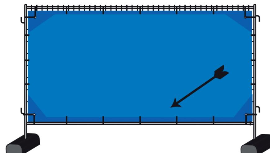
► Serrez les attaches de câble un par un sur les côtés, de manière similaire des deux côtés. Puis serrez les attaches de câble en bas, en commençant par le milieu et en allant vers les côtés
