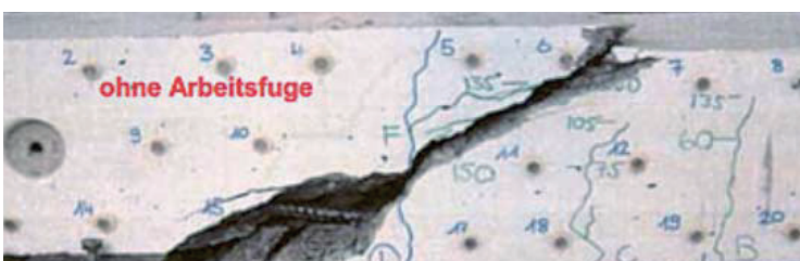
Bruchversagen bei Querkraft- und Momentebeanspruchung ohne Arbeitsfuge
