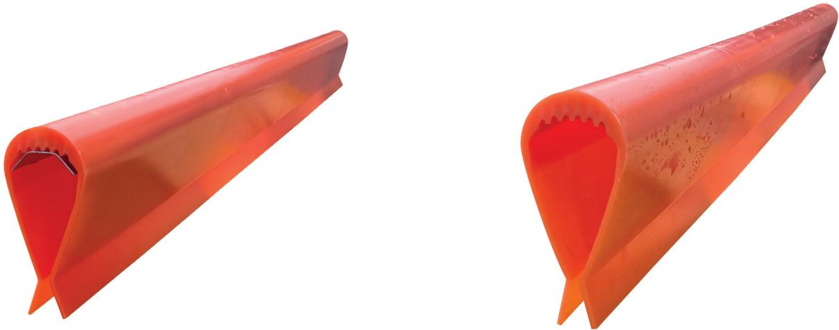
Oranges Schutzprofil aus PVC-freiem Kunststoff für die Sicherung von senkrecht oder waagrecht hervorstehenden Eisenenden. Die innenliegende Wabenstruktur bietet einen erhöhten Schutz, alternativ auch mit einer Stahleinlage für einen noch höheren Schutz.
