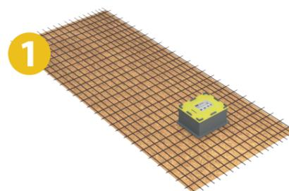
1 Découpe des armatures à l'emplacement de la réservation. Placement et ligature de la RÉZABOITE CV sur le fond de coffrage
