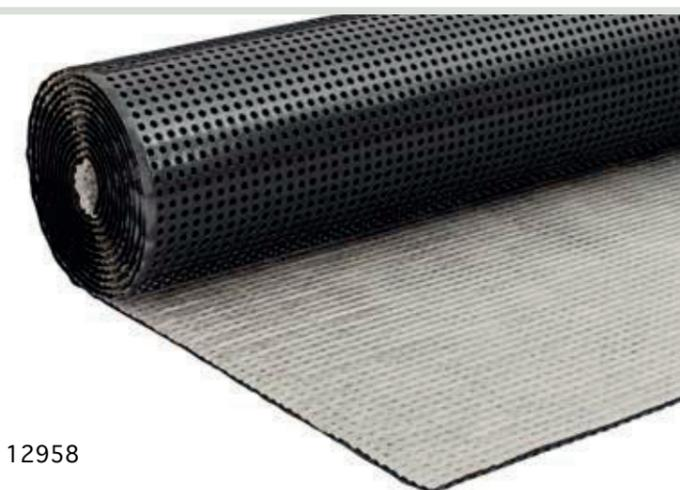
Die Noppenmatte mit aufkaschiertem Drainagevlies schützt die Grundmauerabdichtung vor Beschädigung und sorgt für eine sichere Ableitung von Sickerwasser. Sie schützt das Mauerwerk vor eindringender Feuchtigkeit und sorgt für eine zusätzliche Wärmedämmung. Durch den Filtereffekt wird die Verschlammlung der Noppenzwischenräume verhindert.
