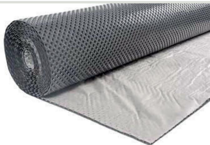
Die Noppenmatte mit aufkaschiertem Drainagevlies schützt die Grundmauerabdichtung vor mechanischer Beschädigung und sorgt für eine sichere Ableitung von Sickerwasser. Sie schützt das Mauerwerk vor eindringender Feuchtigkeit und sorgt für eine zusätzliche Wärmedämmung. Durch den Filtereffekt wird die Verschlammlung der Noppenzwischenräume verhindert.
