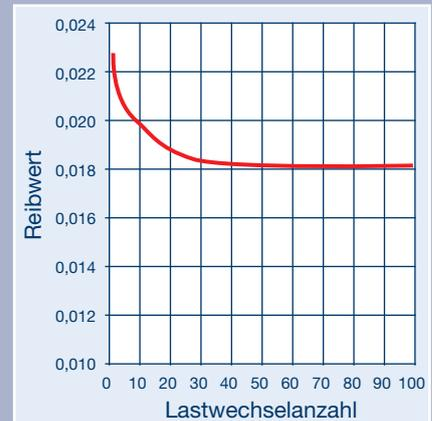
Bild 8: Haftreibungswerte für Ciparall®-Gleitlager, Werte nach Beendigung der Haltezeiten in Abhängigkeit von der Lastwechselanzahl
