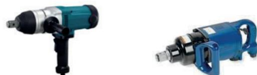
Serrez à fond les boulons de cisaillement à l'aide d'une clé électrique ou pneumatique comme indiqué à la page 18-19. Les boulons doivent être serrés du centre vers l'extérieur (de 1 à 3) jusqu'à ce que les têtes de tous les boulons de cisaillement soient rompus.
