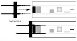
3. Appliquez de la colle au bout du tuyau sur une longueur de 2 cm, puis insérez-la dans le manchon du connecteur. Laissez sécher la colle pendant 15 minutes.
